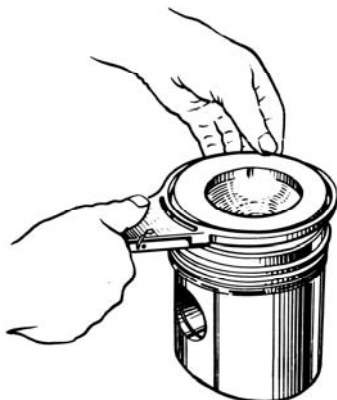
Рис. 95. Снятие и надевание поршневых колец на поршень
