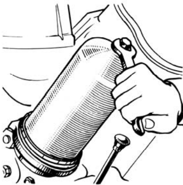
Рис. 67. Отвертывание колпака фильтра
